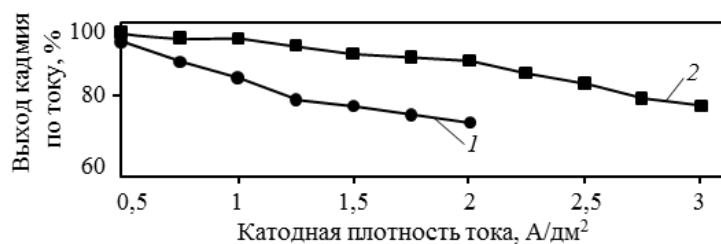
Рис. 1. Зависимость выхода кадмия по току от катодной плотности тока для электролитов с минимальным (1) и максимальным (2) содержанием компонентов в пределах рекомендуемого диапазона при \text{pH}=4 и температуре электролита 25^{\circ}\text{C}
