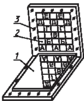
1 — образец, придинутый вплотную к вертикальной поверхности приспособления; 2 — пластина с сеткой или рисунком; 3 — приспособление, состоящее из согнутого под прямым углом листа из органического стекла любого размера
