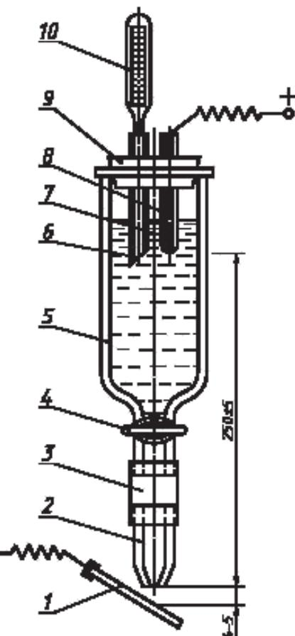
1 — деталь; 2 — капиллярная трубка; 3 — резиновая трубка; 4 — кран; 5 — капельная воронка; 6, 8 — стеклянные трубы; 7 — платиновая проволока; 9 — пробка; 10 — термометр
